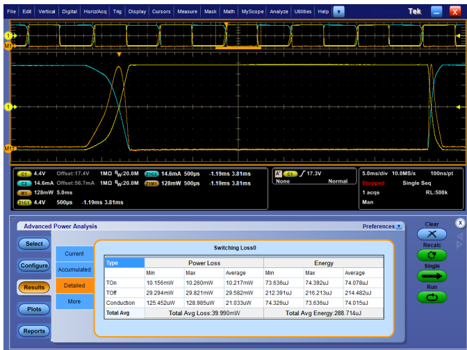
开关损耗测量。自动电源测量可以迅速准确地分析常用的电源参数。
