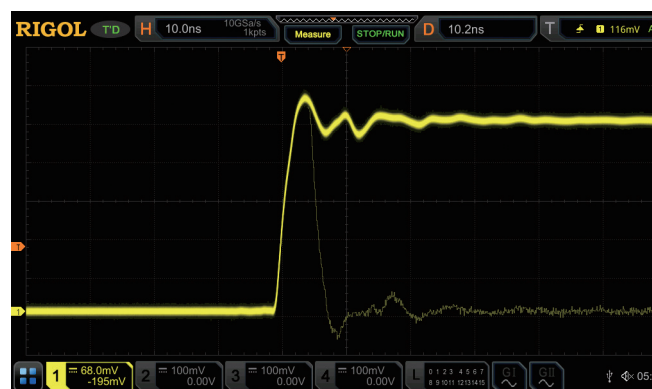
高刷新率模式下捕获偶发异常信号
