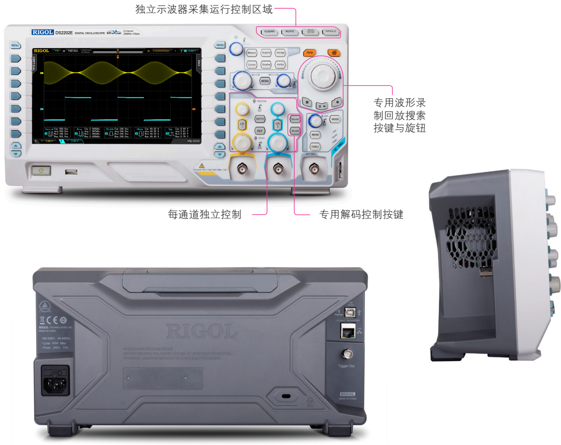
设备尺寸: 宽×高×深 = 361.6 mm × 179.6 mm × 130.8 mm 重量: 3.9 kg ± 0.2 kg (不含包装)
