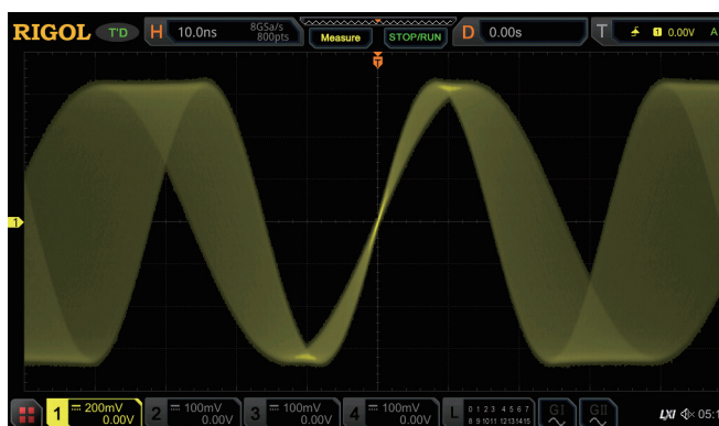
高刷新率模式下扫频信号每一帧的波形变化清晰可见
