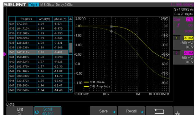
SDS2000X-E 可以控制 USB 任意波形发生器模块或者控制独立的一台 Siglent AWG 设备，执行幅频特性和相频特性扫描，把结果以波特图或者列表方式展现出来，并且可以导出扫描数据。
