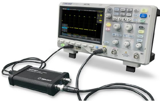
SDS2000X-E 通过 USB Host 接入 25MHz USB 任意波形发生器模块，集成正弦波、方波、三角波、脉冲波、噪声、直流以及 45 种内建任意波，用户也可通过 EasyWave 上位机软件编辑任意波形。
