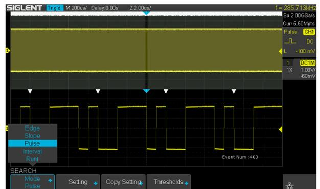
SDS2000X-E 通过指定条件，对一帧波形进行自动搜索，并把搜索结果标识出来，结合导航功能，快速的定位到感兴趣的事件，然后结合示波器的分析功能对事件进行详细的分析，省去了手动搜索的耗时和不便。导航可以对搜索结果按时间和事件导航，也可以对历史帧导航。
