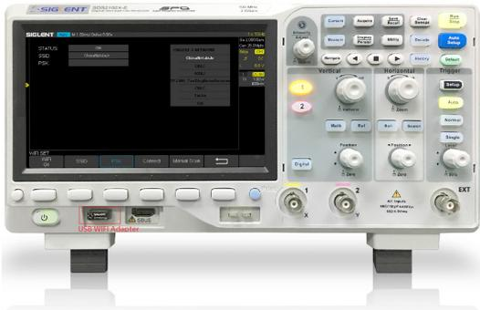
SDS2000X-E 通过 USB Host 接入 USB 无线通信模块，在示波器上输入 Wifi 连接信息，提供无线通信功能。
