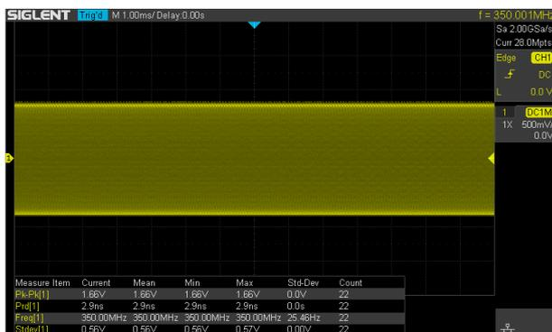
在任一时基下，SDS2000X-E 能对所有的原始采样点完成测量，保证测量精度和采样率的完全同步，可满足高采样率、大存储深度、高精度测量的多重需求。在最大存储深度 28M 的情况下，同样具备极快的运算速度，充分保证了大存储深度下的实时测量和统计功能。
