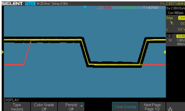
SDS2000X-E 实现了基于硬件的 Pass/Fail 测试功能，每秒执行最高 110,000 次测试。可根据用户自定义的垂直和水平容限，将被测信号与标准规则的同一信号进行比较，适用于长期监测信号或进行生产线测试。
