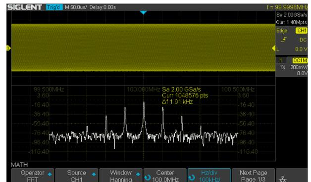
使用专门的协处理器实现高达 1M 点的 FFT，在获得极高的频谱分辨率的同时，还能大大加快频谱的刷新速度；支持多种窗函数以适配不同的频谱测量需求。
