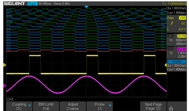
通过外接 16 路逻辑分析仪模块（SLA1016），SDS2000X-E 支持 MSO 功能，最高采样率高达 1GSa/s。
