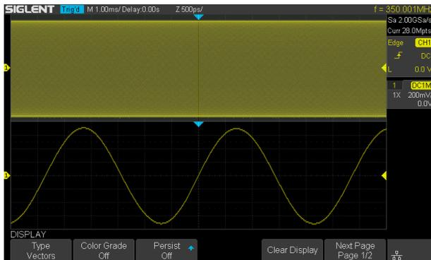
SDS2000X-E 存储深度，通道交织模式为 28Mpts/CH，非交织模式为 14Mpts/CH。用户能够以 2GSa/s 的采样率捕获 14ms 长时间的信号，并结合 Zoom 技术，放大所关注的区域，极大提升了用户可细微捕获的时长。
