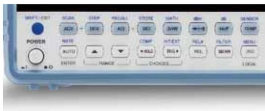
GDM-8261A 所有的的基本测量功能，充分满足了工程师设计、研发和测试电子线路或产品的需要，包括电压、电流、电阻、二极管、短路测试以及频率和温度测量。电流测量功能涵盖范围广泛，包括直流电流 100uA~10A(6 档) 和交流电流 1mA~10A (5 档)。此外，GDM-8261A 还具有 10 种运算功能 (dBm、dB、比较功能和其它数学运算)，满足特殊的测量要求和复杂的测量应用。
