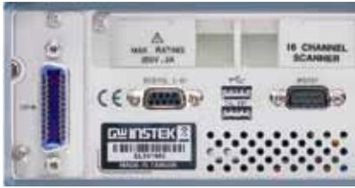
为满足系统的应用需求，GDM-8261A 标配 USB 接口和 RS-232C 接口。连接 USB 接口，以 ASCII 格式传输数据速率可达 2,400 次 / 秒。选配的 GPIB 或 LAN 接口支持一般 ATE 系统的使用。
