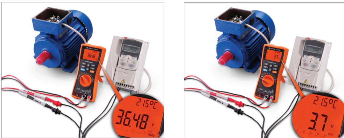
图 2. U1272A 帮助您确定已断开电线(与为工业电机的变频器供电的电线并行)是否存在杂散电压。右图显示了采用低阻抗模式的 U1272A。
