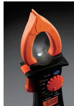
图2. 内置LED手电筒可照亮测试区域
