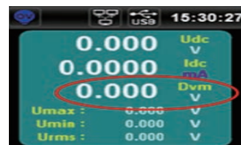
LED测试无过冲电流
